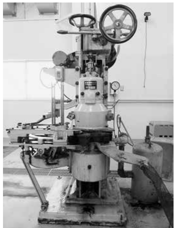
サンフードマシナリー 形式 HCV-805、No. 1224 全景 現在はイチゴジャム (6号缶) やみかんの缶詰 (5号缶) などを製造
